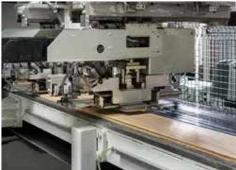
Auffüllen von Ästen und Rissen (vor allem bei rustikalen Sortierungen).
