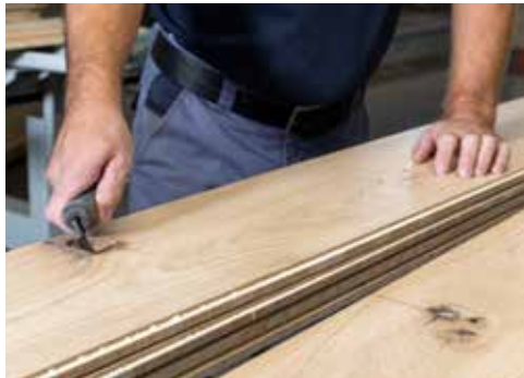
Auskratzen von losen Fasern vor dem Kitten.
