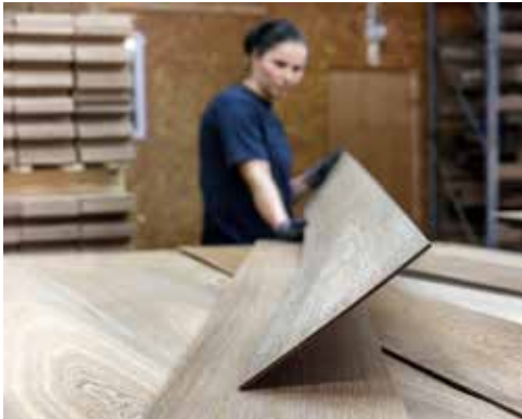
Endsortieren der Decklagen: Das menschliche Auge entscheidet.
