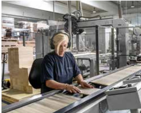
Fertigen der Mittellage aus Gebirgsfichte mit stehenden Jahresringen.
