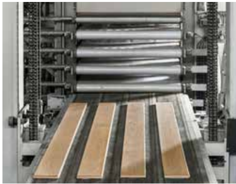
Verpressen der drei spannungsfreien Massivholzschichten.
